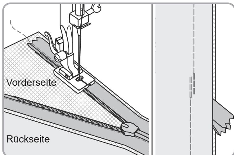
Der Fuß für verdeckte Reißverschlüsse sorgt für einen unsichtbaren Verschluss bei Röcken, Kleidern sowie vielen weiteren Kleidungsstücken und Accessoires.
