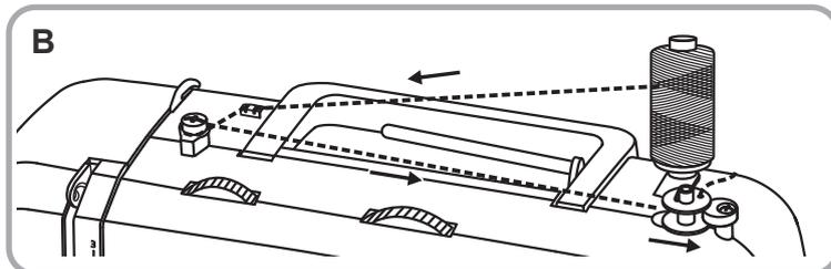
Faden von innen durch ein Loch der leeren Spule (g) nach außen ziehen. Spule (g) auf die Spuleinrichtung (14) stecken und dann nach rechts in die Spulposition drücken.
