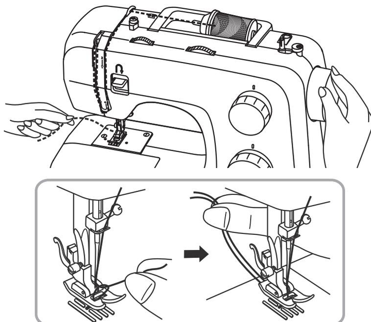
Segure a linha superior com a mão esquerda. Rode o volante (21) para a frente até que a agulha fique completamente subida.
