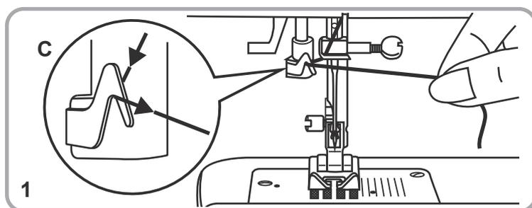
1. Baixe o calcador (9). Passe o fio à volta da guia do fio (C).
