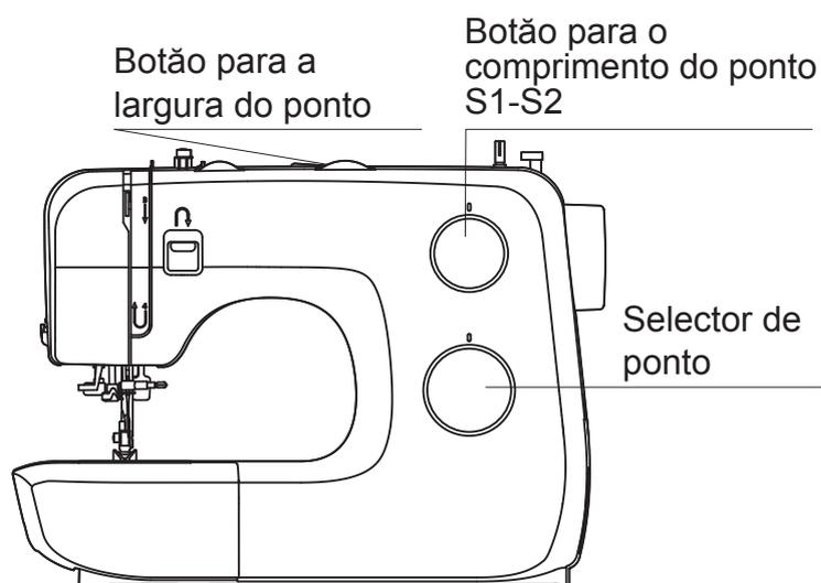
Ajuste da posição da agulha í esquerda ou í direita, rodando o botão de selecção de largura de ponto (4). Ajustar o comprimento dos pontos com o botão de selecção de ponto (5).
